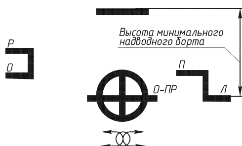
Рис. 14.4.4 Грузовая марка на судах класса «О-ПР» с минимальным надводным бортом
